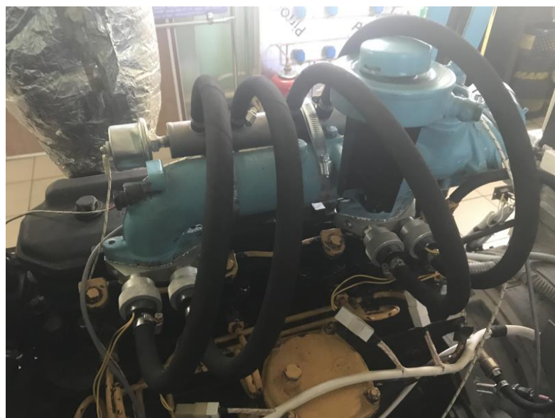
Рисунок 5.2 – Подача газа в газодизельную установку на базе двигателя Д-242
