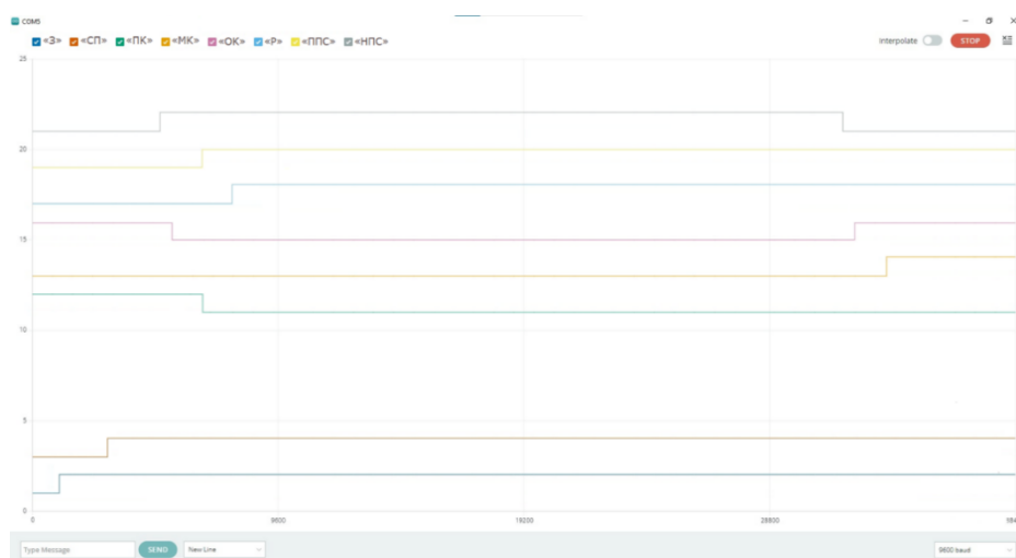
Рис. 2. Временные диаграммы работы двухпроводной схемы управления стрелочным электроприводом
