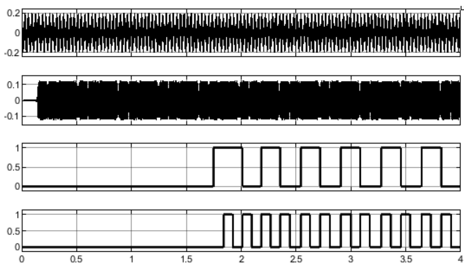
Рис. 2. Осциллограммы сигналов при воздействии гармонической помехи амплитудой 85 мВ на частоте 31 Гц
