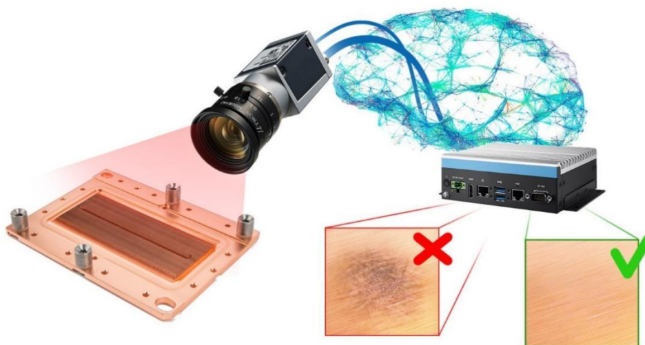
Рис.3. Пример обработки изображения фрагмента детали алгоритмами машинного зрения с элементами искусственного интеллекта.
