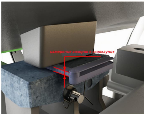
Измерение зазора между скользунами
