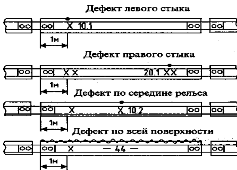
Рис 1 маркировка рельсов в пути (на перегоне)
