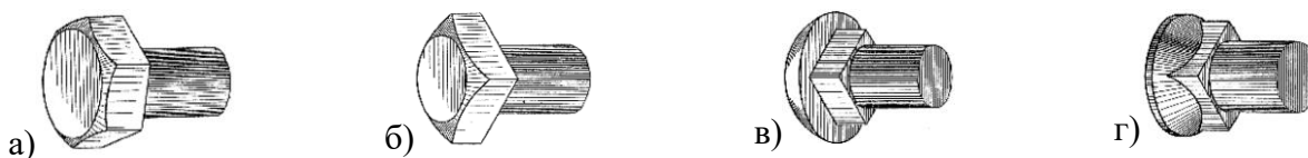
Рисунок 7 Формы головок болтов: а – шестигранная, б – квадратная, в - сферическая с квадратным подголовком, г – потайная с квадратным подголовком
