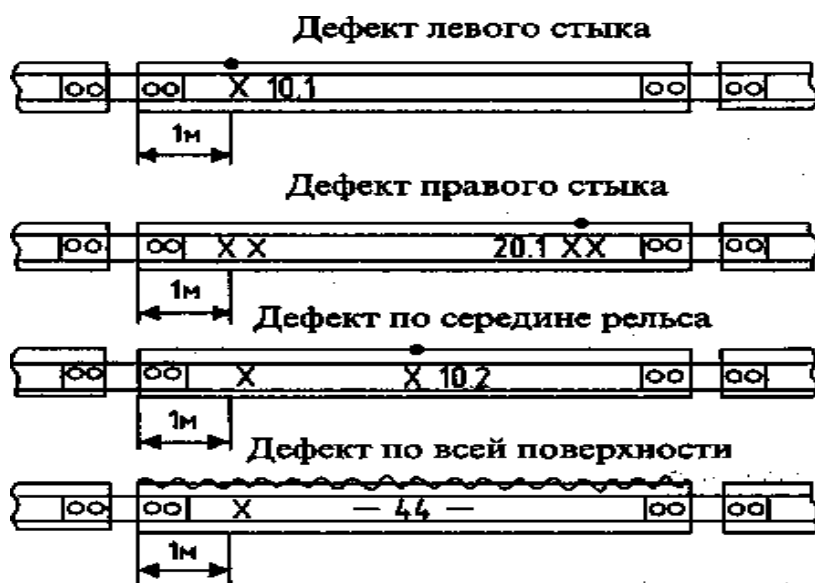
Рис 1 маркировка рельсов в пути (на перегоне)
