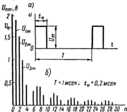
39. Разложить в тригонометрический ряд функцию тока, график которой выражает телеграфные сигналы в случае периодической передачи точек
