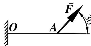
Стержень ОА, находится в вертикальной плоскости, шарнирно закреплен в точке О. Определить модуль горизонтальной силы  $\vec{F}$  при которой стержень находится в равновесии, если угол  $\alpha = 45^\circ$  вес стержня  $G = 5\text{Н}$  приложен посередине стержня  $OC=CA$ .
